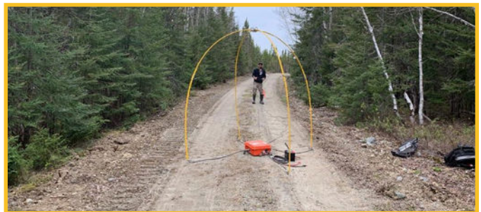
Relevé géophysique - Coffre Pelican avec récepteur et 4 électrodes.
